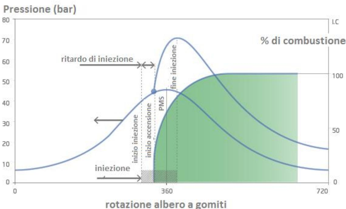
Il numero di cetano è misurato con una strumentazione specifica per la determinazione della qualità del combustibile. Il **metodo standard ASTM D 613 / ISO 5165** prevede la **misurazione con un apposito motore monocilindrico con rapporto di compressione variabile**.
